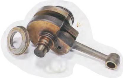
Gebaute Welle: Hubzapfen und Lagerzapfen sowie Kurbelzapfen sind miteinander verpresst, die Kurbelräume der einzelnen Zylinder mit zwei Kolbenringdichtungen voneinander abgeschottet
