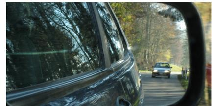
Diese Rückspiegel bestehen aus sogenanntem elektrochromen Glas. Die elektrochromatische Schicht enthält Elektrolyte aus gleichförmigen Kristallen, ähnlich wie ein LCD-Monitor. Legt man nun an diese Schicht elektrische Spannung an, so richten sich die Kristalle in einem bestimmten Winkel aus und die Glasscheibe verdunkelt sich. Die Helligkeit der Scheibe steuern zwei Sensoren. Der Erste erfasst wieviel Helligkeit es in der Umgebung hat, diese Informationen werden an den zweiten Sensor geliefert.
