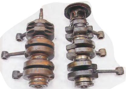
Die Sport-Kurbelwelle unterscheidet sich vom Standard-Teil durch ihre Vollwangen, die die Vorverdichtung im Kurbelraum erhöhen
