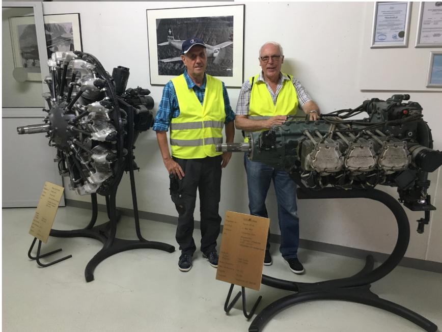
Die aktuellen Pilatus Flugzeuge werden von Turbinen angetrieben, da fehlten unseren Motorenfans natürlich die Kolben, Ventilsteuerungen, etc. Zum Glück fanden sich dann vor der Rückreise ins Bern-Biet doch noch ausgestellte Kolbenmotoren in Stern- und Boxerkonfiguration der früheren Flugzeuge.
