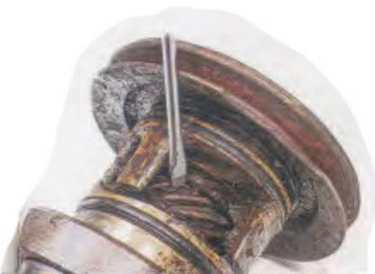
Zwei Jobs auf einmal: Eine Verzahnung vorn auf der Kurbelwelle treibt sowohl den Zündverteiler als auch die Pumpe der Frischölschmierung an
