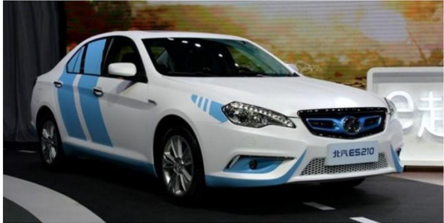
Der Senova ES210EV wird von einem Elektromotor, der von einer 38 kWh Lithium-Ionen-Batterie gespeist wird, angetrieben. Mit einer Leistung von 109 PS schafft er die Höchstgeschwindigkeit von 130 km / h. Die Reichweite beträgt max. 175 km. Er kann an einer 230Volt Steckdose innert acht Stunden vollgeladen werden, mit einem Schnellladegerät lässt die Batterie innert 30 Minuten zu 80 % füllen. So ist er nach einer Kaffeepause schon wieder gut einsetzbar.
