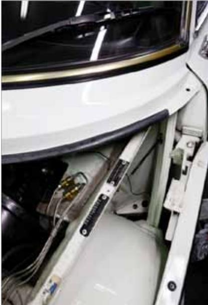
Die Benzin- und Bremsleitungen sind steinschlaggeschützt in den Innenraum verlegt. Nur die Auspuffanlage ist von aussen zugänglich. Wenn ein Saab 99 trotzdem rostet, sind verstopfte Wasserabläufe oder Batterie-säure schuld. Oder es handelt sich um ein sehr vernachlässigtes und gequältes Exemplar. Es gab einzelne Chargen, die mit minderwertigem Blech gefertigt wurden.
