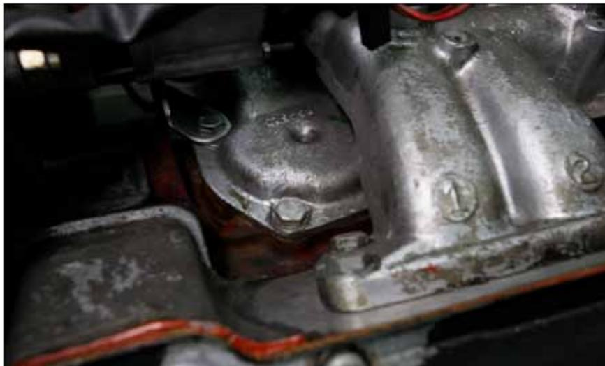
Die diagonal eingebauten Haltebolzen oxidieren, lassen sich nicht mehr bewegen und werden zur Aufgabe für den Motoreninstandsetzer. Bei späteren Saab-Motoren als Vergaser- und Einspritzerversion ist das kein Thema mehr, nur der seltene Turbo ist ein Spezialfall und pflegeintensiver. Sehr frühe Getriebe waren noch mit Freilauf aus seligen 2-Takt-Zeiten ausgerüstet, welche sehr anfällig waren, aber meist schon in der Garantiezeit ausgetauscht worden sind.
